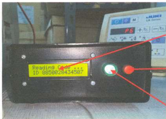
สัญญาณไฟสีเขียวติดสว่างแสดงว่าเป็น TAG ชนิดเดียวกัน (ต่างชนิดกันมีเสียงดังเตือน)
