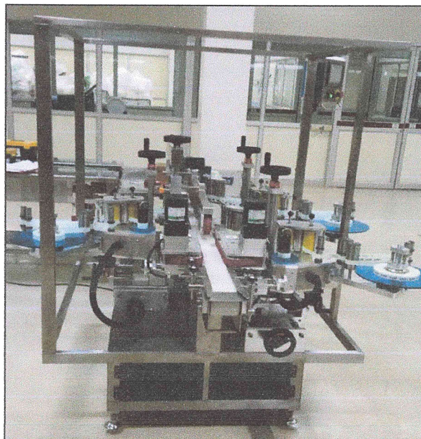
รูปที่ 1.1 เครื่องติดสติ๊กเกอร์กล่องบรรจุ 1 ชิ้น
